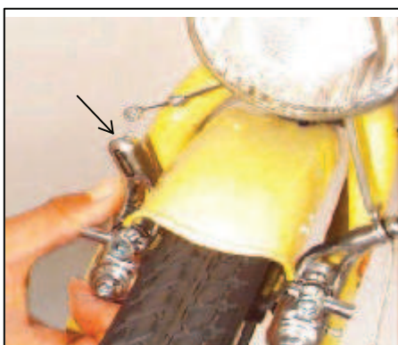
... und in die Cantilever-Bremse einhängen.
