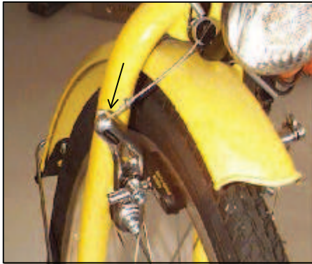
Zug an Cantilever-Bremse aushängen...
